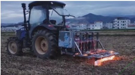
(b) 旋耕后火焰热力消杀处理过程
